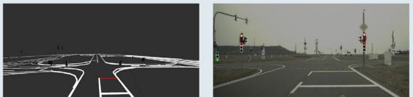
Bildbasierte Ampelerkennung (farbige Boxen: frontale Ampeln mit Phase & Piktogramm, weiße Boxen: nicht-frontale Ampeln) sowie Kartenfusion auf dem Aldenhoven Testing Center
