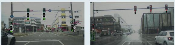
Bildbasierte Ampelerkennung mit Richtungspfeil-Ampeln und Bus-Ampeln in der Stadt
