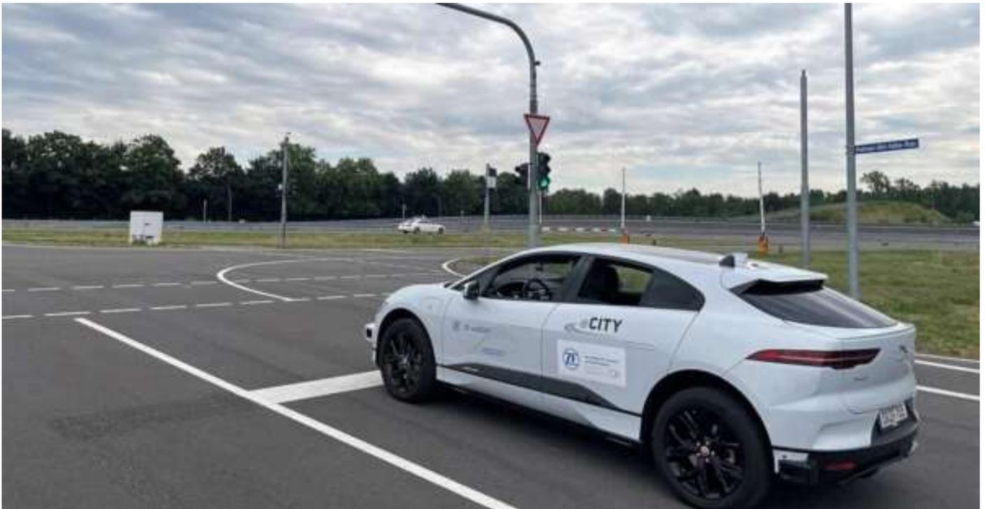
Versuchsträger mit seriennaher Technik: ZF erprobte im Rahmen von @CITY autonome Fahrfunktionen mit einem Testfahrzeug, das auf dem Level-2+-System coASSIST basierte. Es wurde um ein 360-Grad-Lidar-System ergänzt, um im urbanen Umfeld seine unmittelbare Umgebung erkennen und interpretieren zu können. (Bild: ZF)
